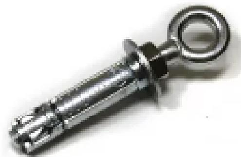
Анкерный болт с кольцом предназначен для монтажа подвесных конструкций, креплений строительных лесов в бетон, природный и строительный камень, полнотелый кирпич. Может применяться для крепления к тонким бетонным перегородкам, а так же тогда, когда есть необходимость подвесить тяжелую конструкцию.
