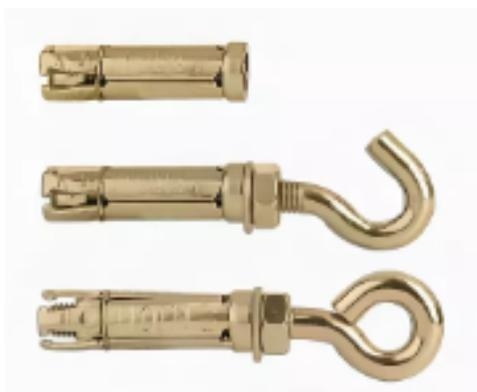
Анкерный болт с кольцом - оптимальный вариант крепления труб и грузов с помощью тросов, канатов, крюков и карабинов. Конусная гайка, навинчиваясь на ножку анкера, расклинивает рубашку, а гайка, прижимающая рубашку со стороны кольца, расклинивание усиливает. Рубашка состоит из нескольких (до четырёх) полос, что делает распор многонаправленным.
