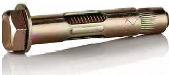
Анкерный болт - одно из лучших устройств для закрепления тяжёлых подвесных конструкций на бетонных или кирпичных стенах. Функцию дюбеля выполняет цилиндрическая муфта. Функцию шурупа - болт. Завинчиваясь, он притягивает конусообразную гайку, сидящую глубоко в стене. Гайка расклинивает углублённый сегмент муфты. Снаружи остаётся только головка болта. Анкерный болт выдерживает серьёзную нагрузку и практически неизвлекаем из стены усилием тяги.
