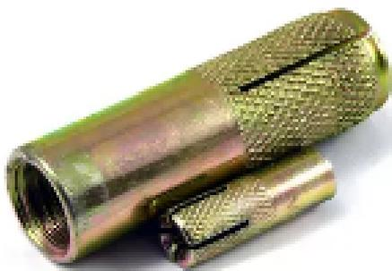
Забивной анкер с внутренней резьбой и конусообразным клином используется при ответственном монтаже (при больших нагрузках), при креплении тяжеловесных конструкций, консолей, кабельных трасс, ворот к бетону, естественному камню, полнотелому кирпичу. Комбинируется с болтом или шпилькой с метрической резьбой. Простой и быстрый монтаж - устанавливается в предварительно просверленное отверстие соответствующее диаметру и длине анкера, расклинивается специальным инструментом. Не подлежит демонтажу.
