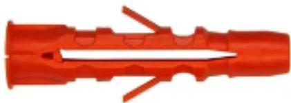
Применяются для монтажа в просверленные отверстия в материалах сплошных (бетон) и пустотелых (полый кирпич). Закрепляемая деталь прижимается головкой шурупа. Дюбель многофункциональный нейлоновый MU выпускается диаметром от 6 до 14 мм, длиной от 35 до 75 мм. В полости кирпича, при завинчивании шурупа, крепёжное изделие скручивается и прижимается к жёсткой стенке.
