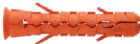
Дюбели для крепления строительных лесов MGD имеют оптимальную форму для фиксации в бетоне или кирпиче, предназначены для ввинчивания шурупов-колец. Диаметр изделия равен 14 мм, длина - от 70 до 140 мм. Выбирать их следует в зависимости от типа и толщины опорных стен. Сделаны из полиамида PA6. Устойчивы к скачкам температуры воздуха, жаре, морозу, уровню влажности.
