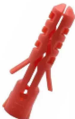
Шахматный порядок фиксирующих выступов на дюбелях нейлоновых MN избавит от проскальзывания дюбеля на этапе вкручивания шурупа. В дюбелях Mungo MN ширину продольных прорезей страхуют поперечные фиксаторы, это сделано для того чтобы не произошло преждевременного расклинивания дюбеля в момент забивания.
