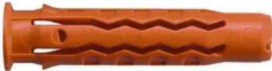
Дюбели универсальные нейлоновые Quattro MQ применяются для крепления предметов интерьера, украшений, электрических приборов на кирпичных и бетонных стенах. Подходят к шурупам любого типа. Обтекаемая конфигурация дюбеля Quattro MQ позволяет устанавливать его в отверстие без применения специального инструмента. Наличие бортика - страхует от излишнего заглубления. Диаметр изделий - от 5 до 14 мм, длина от 25 до 60 мм.
