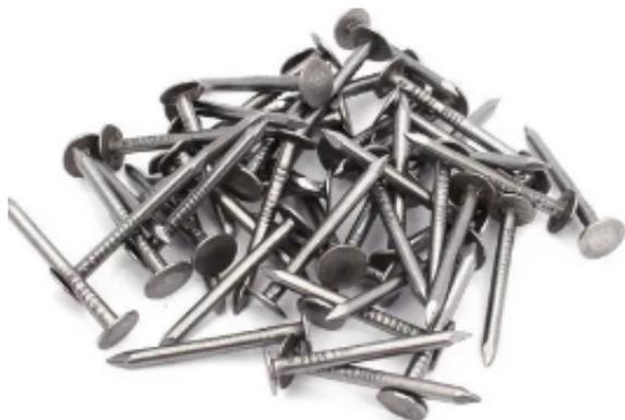
Гвозди кровельные оцинкованные используют для крепления кровли на деревянном основании. Стальные изделия покрыты цинком, не боятся влаги. Имеют шляпку БОльшего диаметра, чем строительные гвозди. Это позволяет надёжно прижимать относительно мягкие материалы (толь, рубероид и т.д.), не повреждая их. Диаметр стержня от 2 до 3 мм, длина от 20 до 100 мм. ГОСТ 4029-63.
