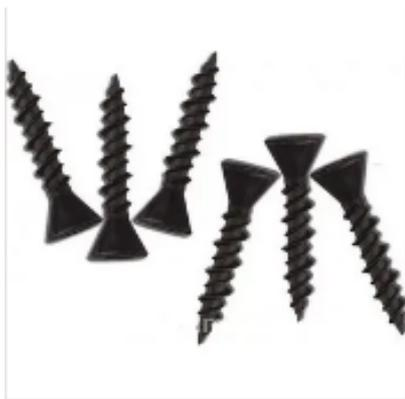
Саморез для крепления гипсоволоконных плит, уменьшенная потайная головка PHILLIPS №2, с насечками для раззенковки, острый наконечник, двухзаходная резьба, оксидированный.
