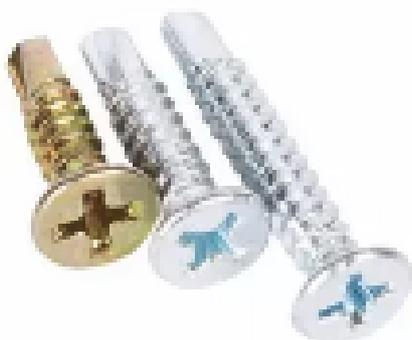
Самосверлящий наконечник оконного самореза-шурупа со способностью просверливания до 2,0 мм обеспечивает быстрый и надежный монтаж. Благодаря оптимально подобранной высоте головки, зенкующим и предохраняющим от раскручивания насечками появляется возможность соединять тонкостенные пластмассовые профили с усиливающими элементами.
