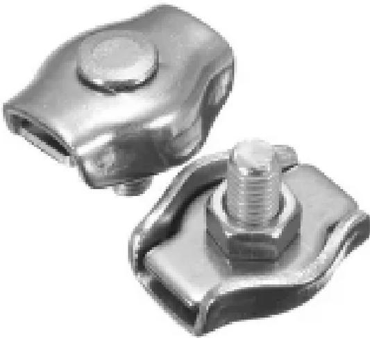
**Зажим для троса SIMPLEX** – надёжная деталь при формировании канатных петель и сращивании порванного троса, толщиной от 2 до 10 мм. Используется в оснащении подъёмных кранов, пассажирских лифтов и других грузоподъёмных механизмов, эксплуатация которых требует особой надёжности. Сделан из стали с оцинковкой. Является пластиной с краями изогнутой конфигурации и винтом, на который насаживаются верхняя пластина и гайка. Гайка заворачивается как торцевым, так и рожковым ключом.
